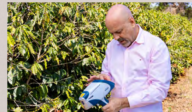
Técnica de fluorescência de raios x, para coleta de dados das lavouras
